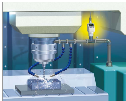
クーラント液の圧力管理
